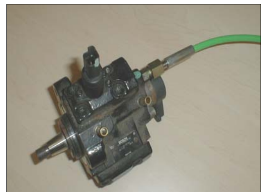
Messleitungsanschluss an Hochdruckpumpe
