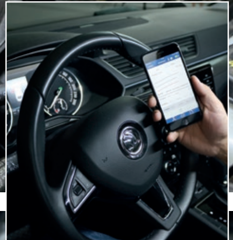
"1-Mann-Prüfung" vom Fahrersitz, d.h. Starter betätigen und gleichzeitig die Kompressionsdruck-Messwerte ablesen.
