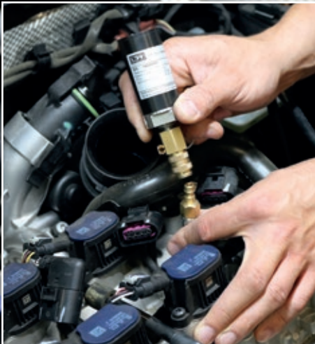
Verbinden/Kuppeln des Sensor mit dem Adapters.
